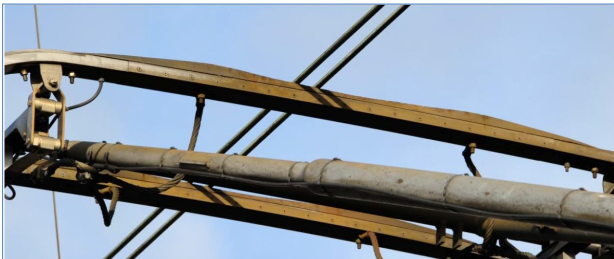
Abb. A2.2: Lokal konzentrierte Abnutzung einer Schleifleiste bei einem Fahrdrabt-Zick-Zack von \pm 200 mm in Belgien (Foto: Torsten Giesen)
