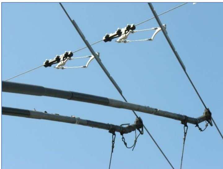
Abb. A2.4: Stromabnehmerstangen an Fahrdrabt in Pendelaufhängung Quelle: Dr. R. M. Bergmaier, Moderne Fahrleitungssysteme für Trolleybusse, 2009.
